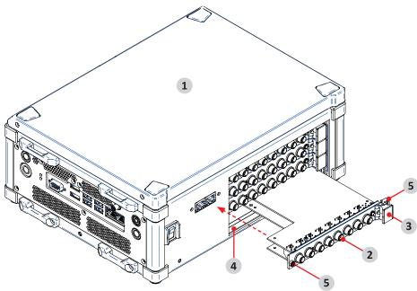
Fig. 18: Installing a TRION module
